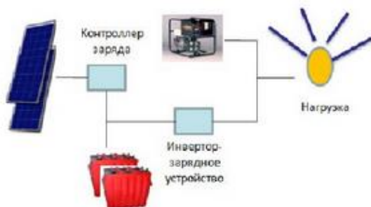
Рис. 2. Блок-схема гибридной энергоустановки на основе фотоэлектрических модулей и теплового двигателя для малых (до 10 кВт) потребителей
