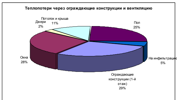
Рис. 1. Теплопотери в типовом проекте О–003–3 жилого дома ЖБК-1
