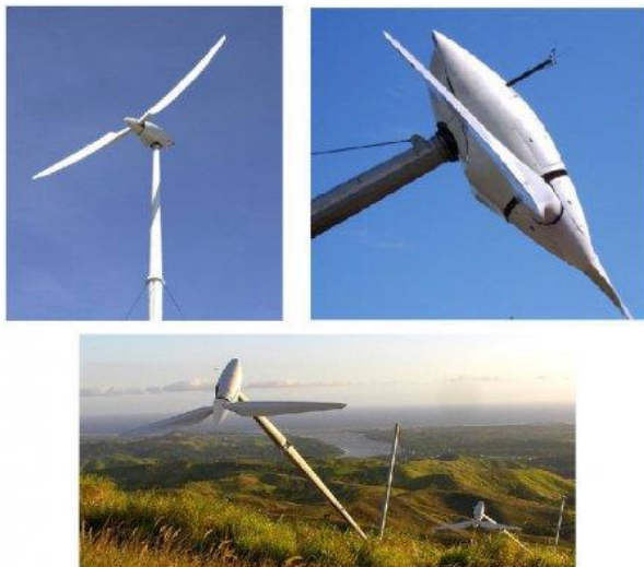
Двухлопастная ВЭУ, модель Gev MP, мощностью 275 кВт, Vergnet S.A.
