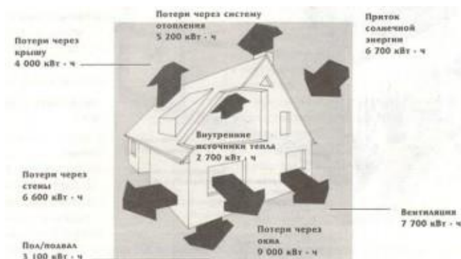
Рис. 1. Потери теплоты в индивидуальном доме [1]
