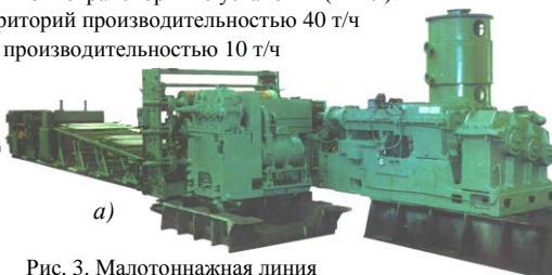
Рис. 3. Малотоннажная линия производства листовых материалов из отходов производительностью до 1 т/ч (а), б) образцы стройматериалов из отходов
