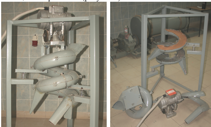
Рисунок 1. Лабораторная установка инерционного грохота с геликоидной просеивающей поверхностью
