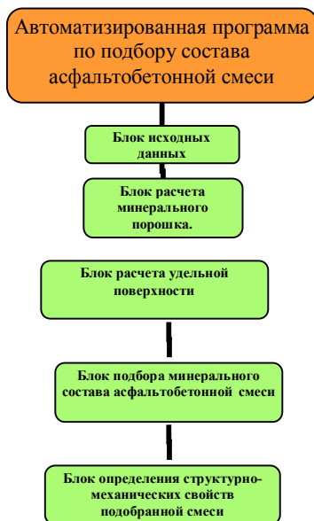
Рисунок 1. Общая структура алгоритма автоматизированного проектирования состава асфальтобетонной смеси
