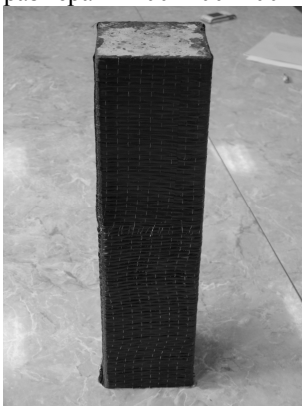
Рис. 2. Усиленная призма углеродной тканью
