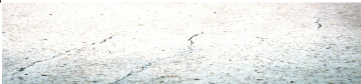
Рисунок 2 – Структура цементобетонного камня с развитой сетью трещин карбонизации
