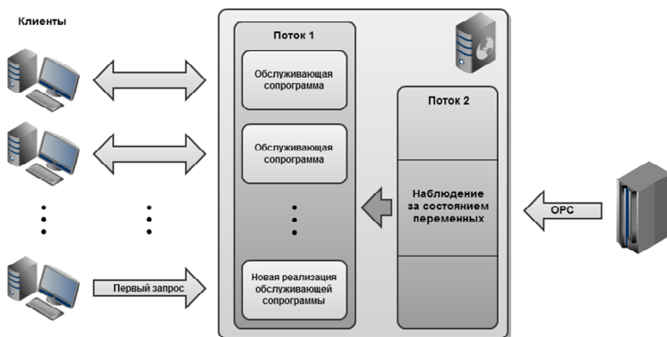
Рисунок 4. Взаимодействие потоков и сопрограмм в рамках обработки заявок
