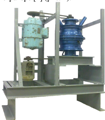
Рис. 4. Дезинтегратор с внутренним рециклом измельчаемых материалов
