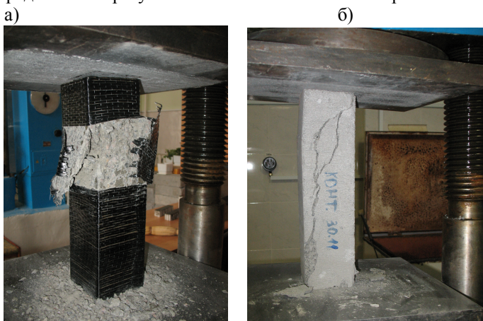
Рис. 3. Характер разрушения бетонных призм: а) усиленной; б) не усиленной
