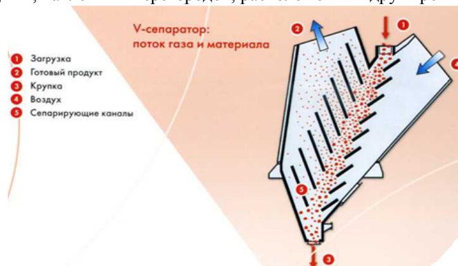
Рис. 12. Схема каскадного воздушного сепаратора KVT
