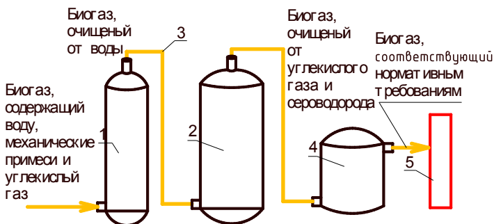
Рис. 1. Трехступенчатая схема очистки биогаза
