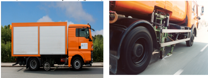
Рис.2 – Машина для измерения коэффициента сцепления:
