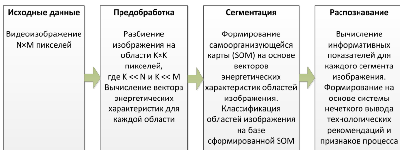
Рис. 2. Этапы обработки видеоизображения процессов во вращающейся печи
