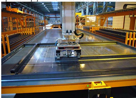
Рис. 15. Плоттер-робот для установки опалубки
