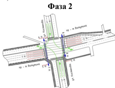
Рисунок 4. Направления движения во 2-ой фазе регулирования на пересечении пр-та Ватутина – ул. Костюкова
