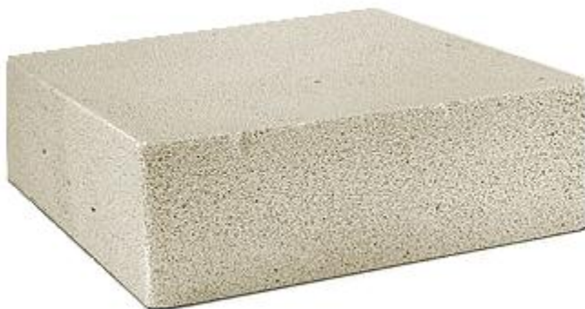
Рис. 2. Общий вид разработанного пеностекла
