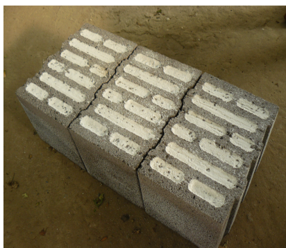
Рис. 5. Стеновые блоки компании Liapor GmbH, прошедшие натурные испытания в ООО «Интеллект-Сервис ЖБК-1» г. Белгород
