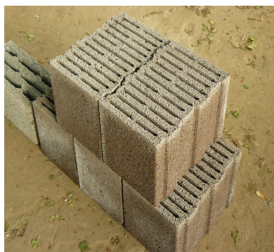
Рис. 5. Стеновые блоки компании Liapor GmbH, прошедшие натурные испытания в ООО «Интеллект-Сервис ЖБК-1» г. Белгород
