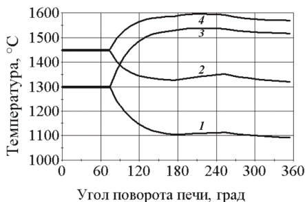
Рис. 2. Изменение температуры внутренней поверхности футеровки вращающейся печи при температуре слоя клинкера 1300 °С и 1450 °С: 1, 2 – в зоне охлаждения клинкера; 3, 4 – в зоне спекания клинкера
