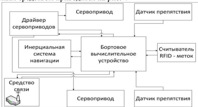
Рисунок 4 – Структура системы управления автоматизированного транспортного средства
