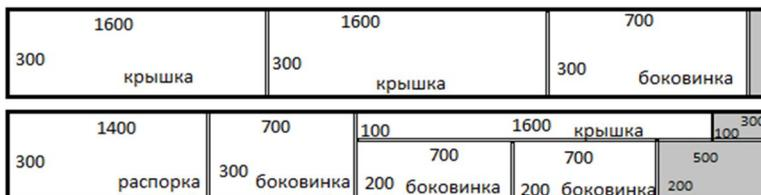
Рисунок 1 – Схема раскроя доски на прямоугольные заготовки
