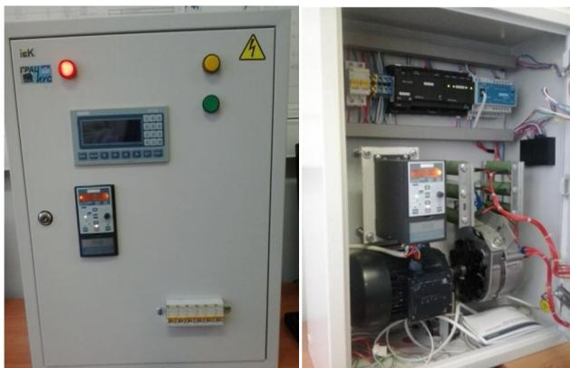
Рисунок 2 – Фото УПТК для изучения преобразователя частоты
