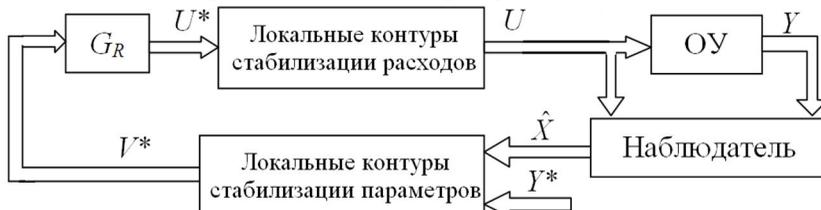
Рисунок 2 – Структурная схема связанной системы стабилизации
