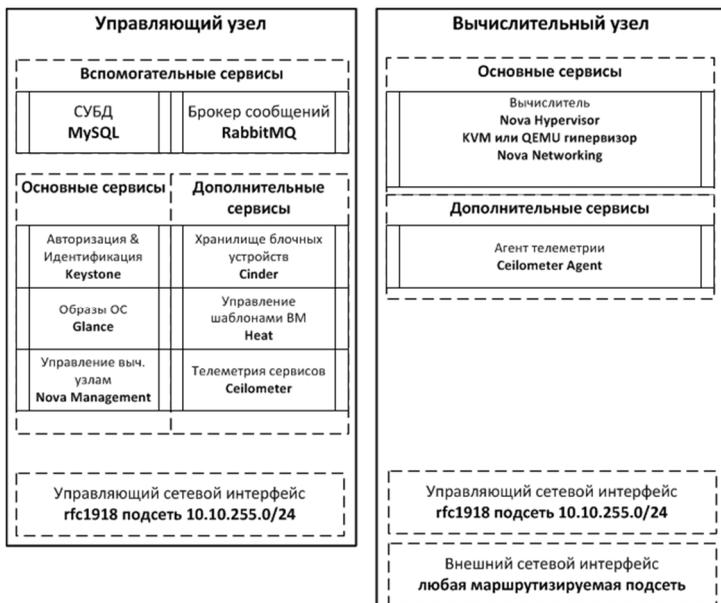
Рисунок 2 – OpenStack-реализации архитектуры
