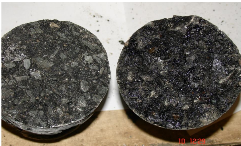
Рисунок 1 – Асфальтобетонный керн, отобранный на перроне (П) в аэропорте «Домодедово» (справа) и керн с участка ПОЖ, совмещенной с РД, подверженный процессу «старения» (слева)
