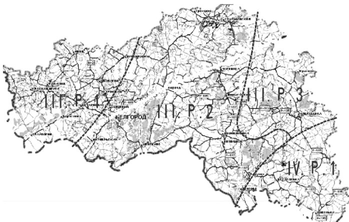
Рисунок 2 – Схема дорожно-климатического районирования территории Белгородской области: III, IV – дорожно-климатические зоны; P – подзона по типу рельефа (равнинный); 1 – 3 – номера дорожных районов
