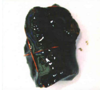
а – БНД 60/90 без добавки; б – БНД 60/90 с добавкой ДАД-ГА-2 (0,6%) Рисунок 1 – Фотографии адгезии битума с каменным материалом
