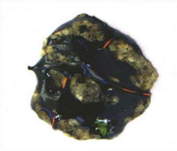
а – БНД 60/90 без добавки; б – БНД 60/90 с добавкой ДАД-ГА-2 (0,6%) Рисунок 1 – Фотографии адгезии битума с каменным материалом
