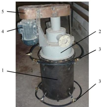
Рисунок 1 – Мельница пневмоструйная: 1 – камера помола, 2 – классификатор, 3 – коллектор подачи сжатого воздуха, 4 – электродвигатель привода классификатора, 5 – защитный кожух клиноременной передачи
