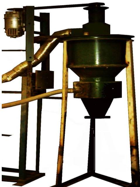
Рисунок 1 – Динамический центробежный сепаратор
