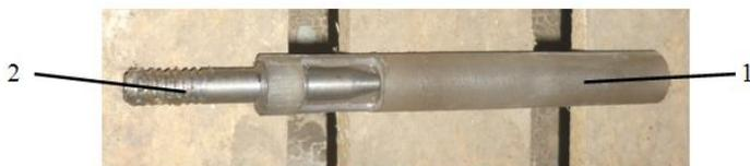
Рисунок 2 – Разгонная трубка: 1 – труба, 2 – сопло
