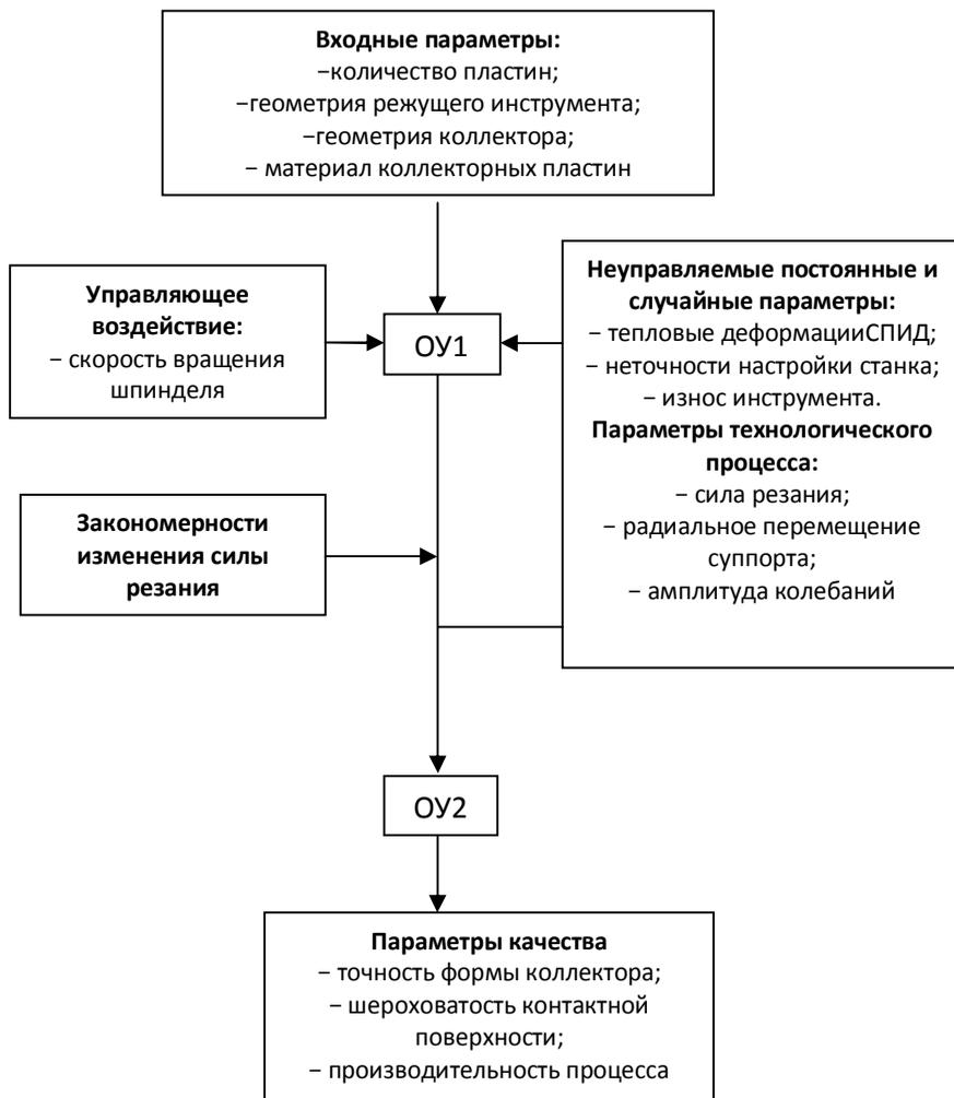
Рисунок 1– Структурная схема технологического процесса обработки коллектора
