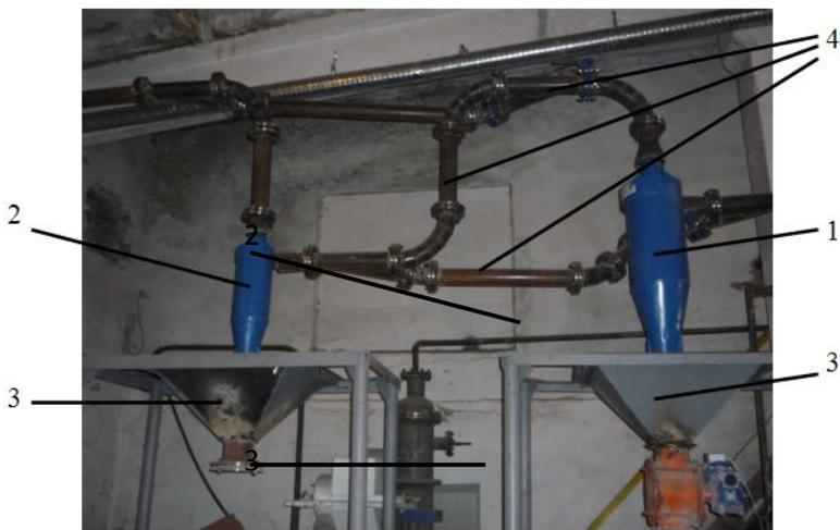
Рисунок 6 – Пылеосадительное оборудование: 1 – циклон СЦН-40-300, 2 – циклон СЦН-40-200, 3 – бункеры, 4 – газоходы
