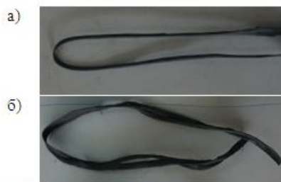
Рисунок 2. Общий вид волокон, покрытых микрокремнеземом, толщиной пряжи 800 г/км (а) и 3300 г/км (б), по третьей
