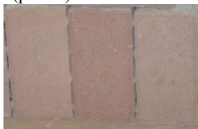
Рисунок 2 – Пример влияния температуры среды в камере твердения на цвет изделий (слева – образец, твердение которого происходило при t=23^{\circ}\text{C} , справа – при t=20^{\circ}\text{C} , по центру – при t=17^{\circ}\text{C} )
