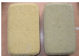
Рисунок 1 – Пример влияния характерного цвета цемента при одинаковой дозировке желтого пигмента (слева – изделие на белом цементе, справа – изделие на сером цементе) (слева – изделие на белом цементе, справа – изделие на сером цементе)
