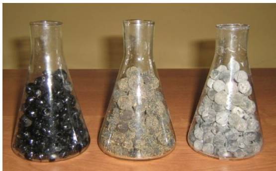
Рисунок 1 – Варианты получения искусственного наполнителя в форме гравия. Слева направо – с обработкой поверхности битумом, с последующей обсыпкой кварцевым песком или опудриванием конверсионным карбонатом кальция
