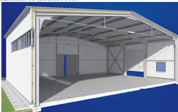
Рисунок 3 – Конструктивное решение рамных конструкций производства ЗАО «Эксергия» (г. Липецк)
