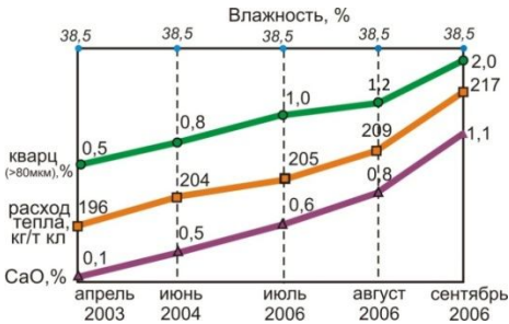
Рисунок 1 – Воздействие крупнозернистого кварца (> 80 мкм) на удельный расход условного топлива и содержание CaO_{св} в клинкере на ЗАО «Осколцемент»
