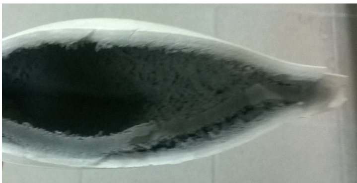
Рисунок 1 – Деформация образца и дефект «черная сердцевина» при обжиге по режиму №1
