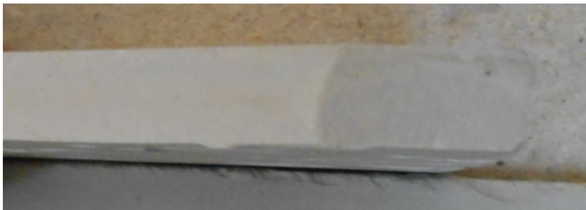
Рисунок 4 – Образец после обжига при режиме №3 с увеличением температуры в зоне предварительного нагрева на 10°C
