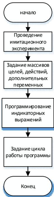
Рисунок 4 – Блок-схема алгоритма построения управляющего автомата
