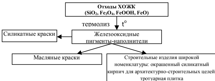
Рисунок 2 – Схема утилизации металлсодержащих отходов КМА
