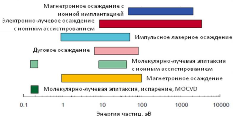
Рисунок 6 – Диапазоны энергий осаждающихся частиц для различных методов нанесения покрытий [25]
