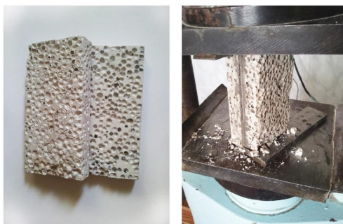
Рисунок 3 – Характер разрушения силикатных материалов с АГЗ при использовании упрочненных кладочных растворов
