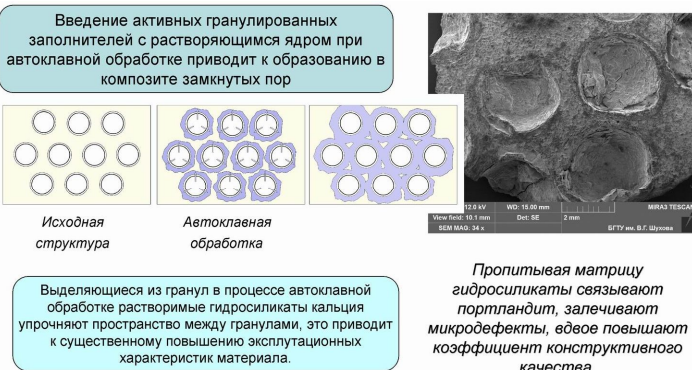
Рисунок 2 – Конструкционно-теплоизоляционный стеновой материал и композиционного кладочного раствора для сейсмостойкого строительства
