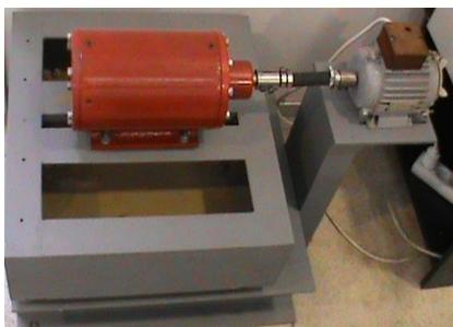
Рисунок 1 – Опытно-промышленный образец вибратора направленных действий с виброгенератором кассетного типа
