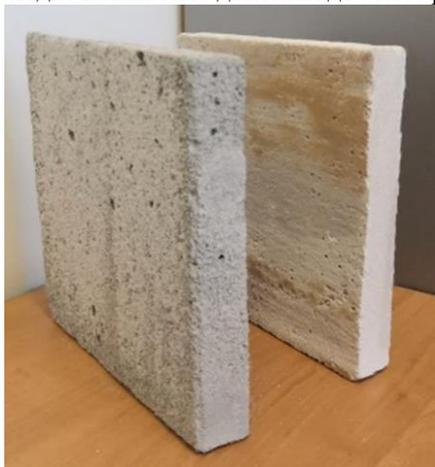
Рисунок 2 – Образцы газобетонных композитов
