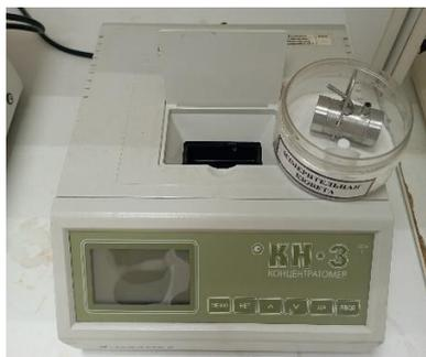
Рисунок 2 – Концентратомер КН-3 и измерительная кювета
