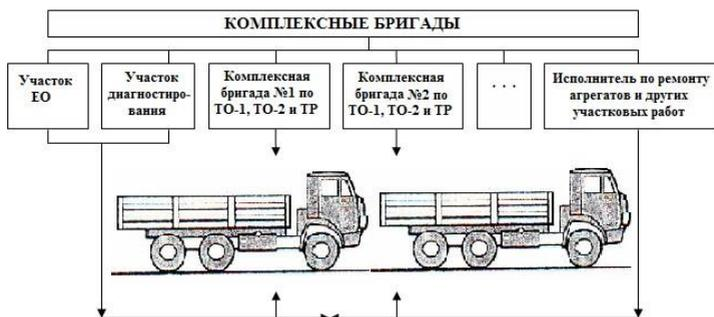
Рисунок 3 – Схема обслуживания подвижного состава методом комплексных бригад
