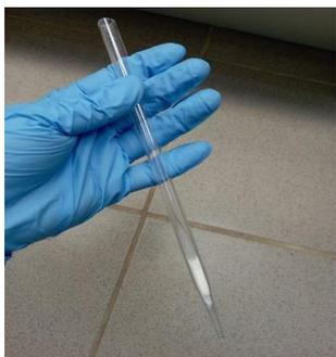
Рисунок 1 – Подготовленная хроматографическая колонка
