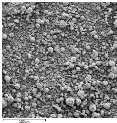
Рисунок 3 – Микроструктура прокаленного при 600°C дефеката
