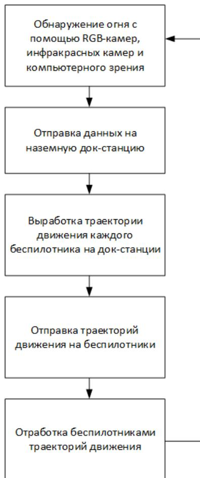
Рисунок 1 – Схема системы определения и мониторинга изменения областей возгорания на местности с применением группы БПЛА
