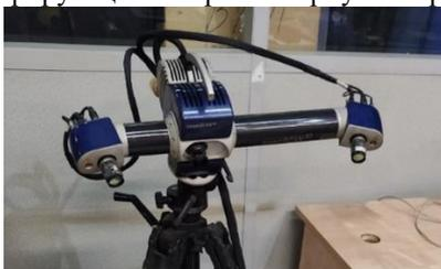
Рисунок 1 – 3D-сканер – Breuckmann Smartscan 3D-HE
