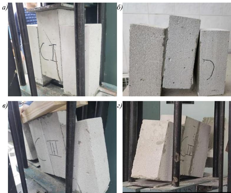
Рисунок 5 – Общий вид образцов после испытания на сопротивление сдвигу:
