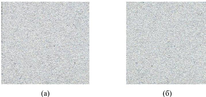
Рисунок 2 - Внешний вид покрытий до и после испытаний: (а) исходное покрытие, (б) после испытаний в растворе NaCl
