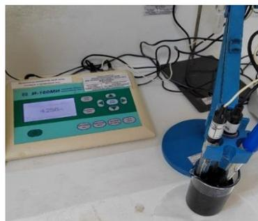
Рисунок 3 – Лабораторный иономер «И-160МИ»
