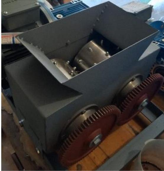
Рисунок 2 – Экспериментальная установка ПВУ с шипованными валками
