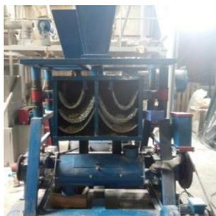
Рисунок 1 – Вибро-центробежный агрегат комбинированного действия
