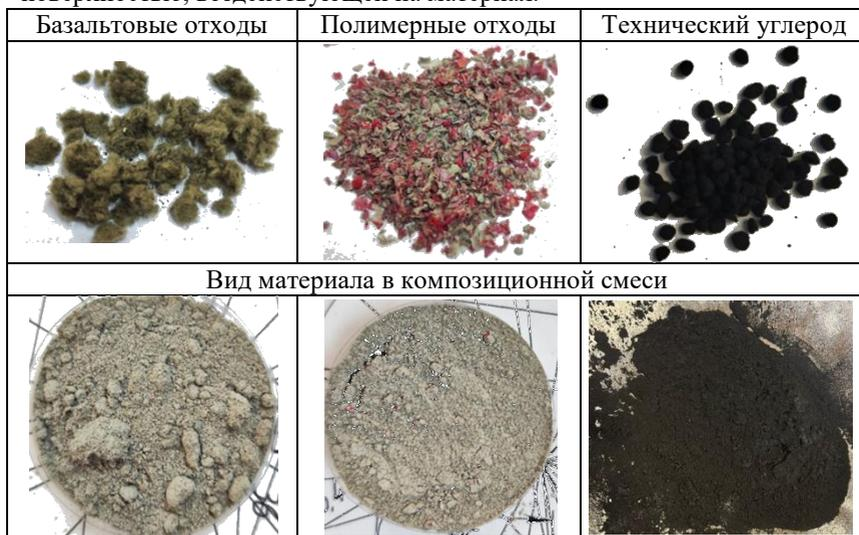
Рисунок 1 – Композиционные смеси с техногенными компонентами
