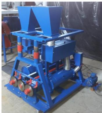
Рисунок 2 – Вибрационно-центробежный агрегат для классификации техногенных волокнистых отходов
