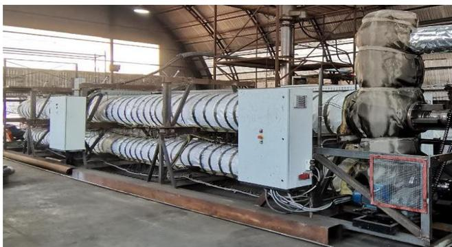
Рисунок 2 – Опытно-промышленная установка низкотемпературного термолиза органических ТКО производительностью  $Q=500$  кг/час
