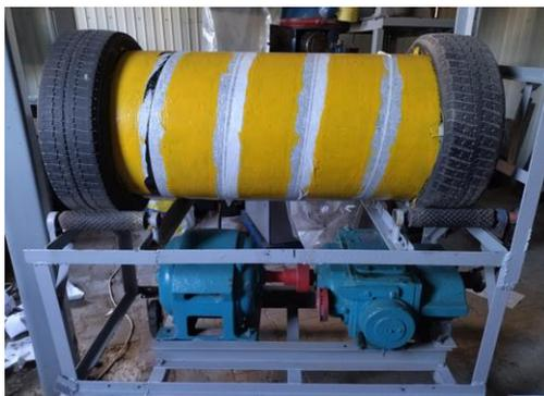
Рисунок 3 – Барабанно-винтовой агрегат для агломерирования полидисперсных материалов с низкой насыпной плотностью.
