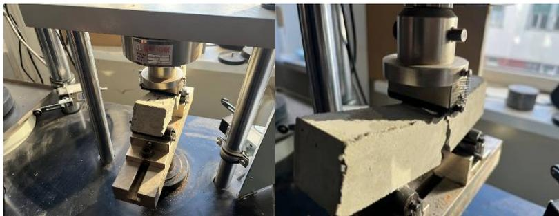
Рисунок 3 – Испытание образцов серии NiTi-0 до разрушения
