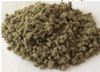
Рисунок 3 – Гранулированный базальтовый волокнистый наполнитель
