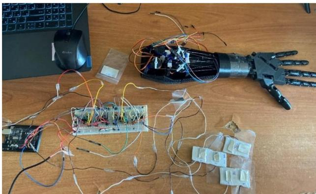
Рисунок 3 – Напечатанный на 3d-принтере манипулятор, датчики arduino и EMG
