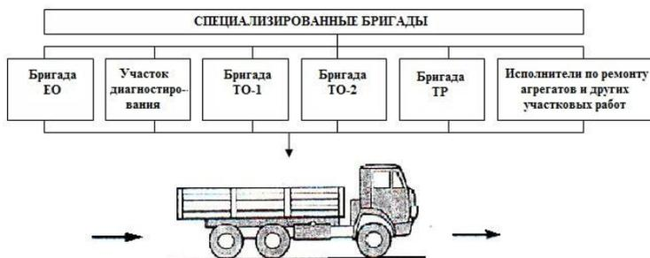
Рисунок 2 – Схема обслуживания подвижного состава методом специализированных бригад
