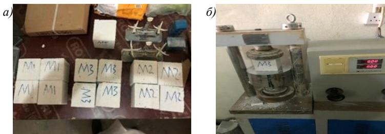
Рисунок 1 – Испытания образцов на прочность при сжатии: *а* – образцы для испытаний; *б* – установка для испытаний
