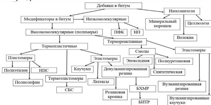
Рисунок 1 – Используемые наполнители для битумного вяжущего
