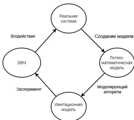
Рисунок 1 – Алгоритм работы имитационного моделирования
