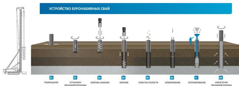
Рисунок 2 – Устройство буронабивной сваи
