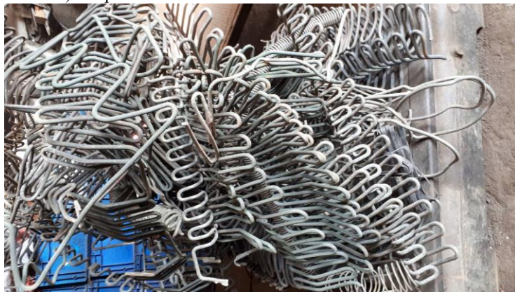
Рисунок 2 – Результаты деградации нихромовых изделий в условиях высоких температур
