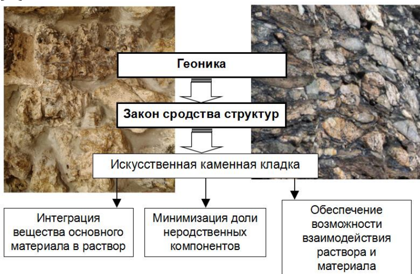
Рисунок 1 – Искусственный материал и его природный аналог: а) каменная кладка (слева); б) природный конгломерат сланца, песчаника, граувакка (справа)
