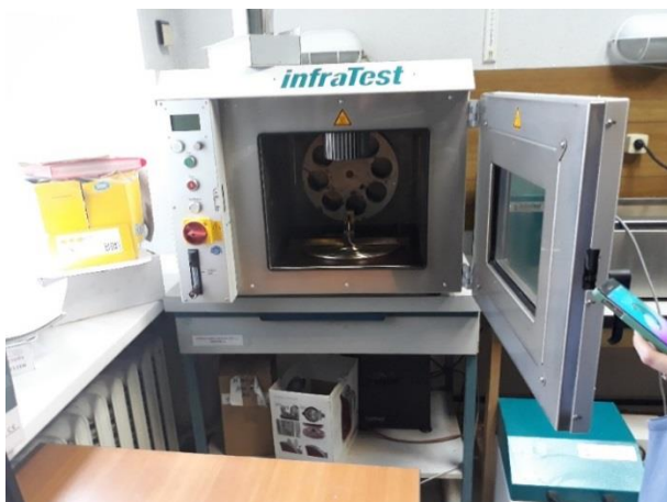
Рисунок 1- Прибор для старения битума в тонких пленках RTFOT
