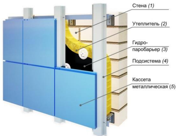
Рисунок 4 - Схема устройства вентилируемых фасадов
