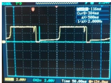
Рисунок 2 - Выходной сигнал при отклонении вправо от линии
