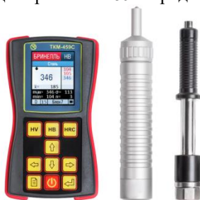
Рисунок 1 - Внешний вид твердомера ТКМ-459С с набором двух типов датчиков для измерений
