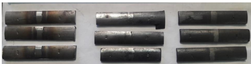
Рисунок 3 – Фотография сегментов: №1 без термообработки (а), №2 после закалки (б) и №3 после стабилизирующего отжига (в)
