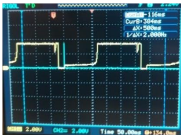
Рисунок 2 - Выходной сигнал при отклонении вправо от линии движения
