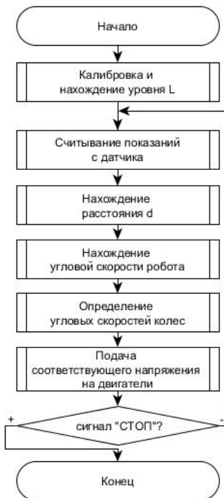
Рисунок 4 - Блок-схема алгоритма движения робота по контрастной линии
