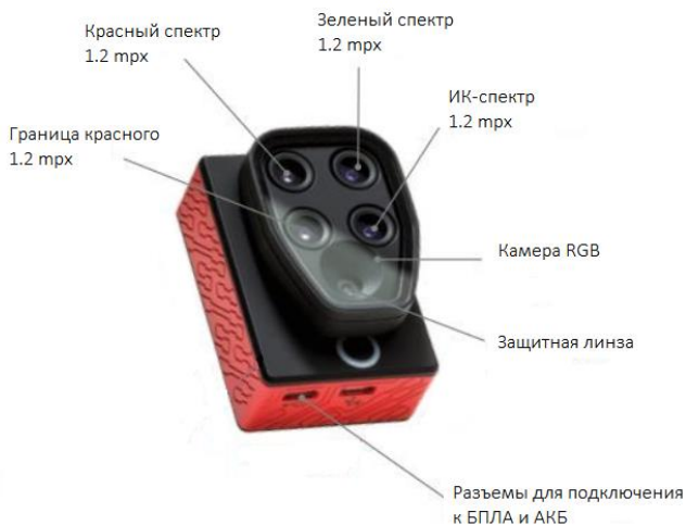
Рисунок 1 - Мультиспектральный сенсор Parrot Sequoia
