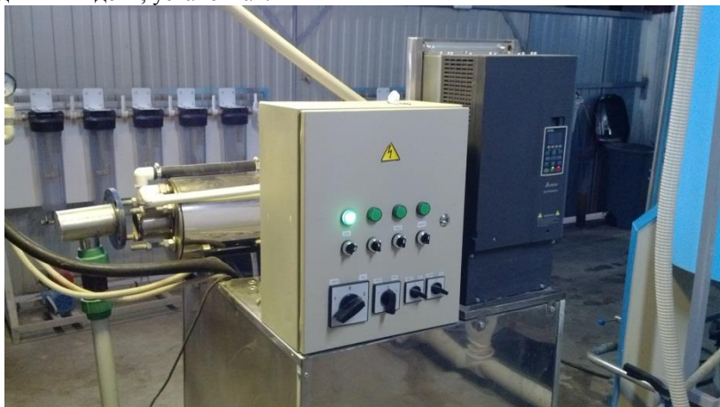
Рисунок 2 - Аппарат вихревого слоя с аппаратурой управления конструкции ООО «Пром-Эко», г. Белгород, партнёр БГТУ им. В.Г. Шухова
