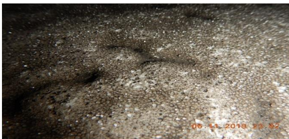
Рисунок 5 - Сохранность микростеклошариков на материалах с разными значениями текучести на одном опытном участке
