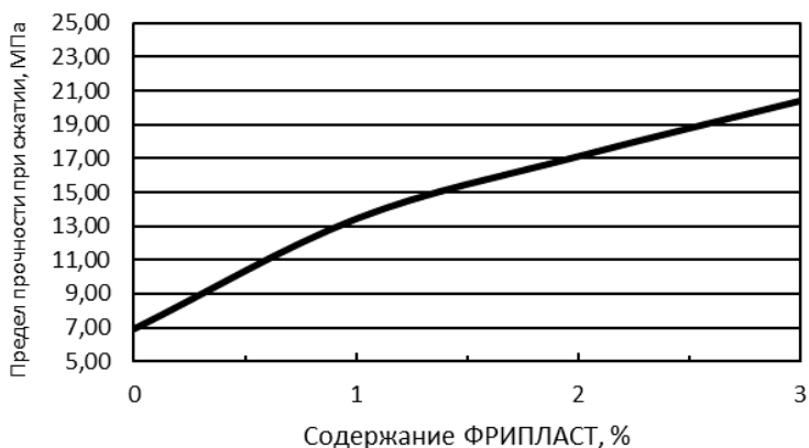
Рисунок 4 - Влияние содержания добавки Фрипласт на прочности при сжатии
