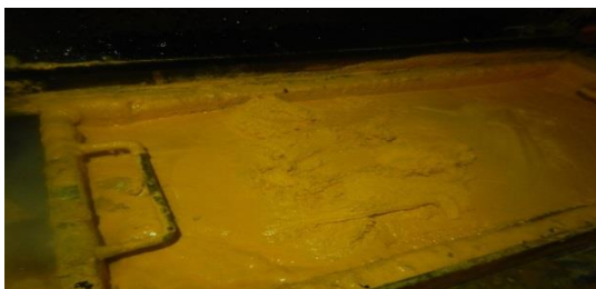
Рисунок 10 - Заправка котла разметочной машины тугоплавким термопластиком
