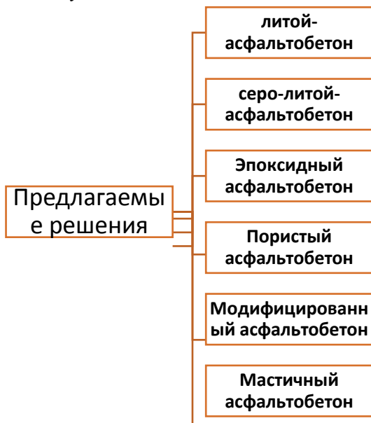
Рисунок 10 - Предлагаемые смеси для реконструкции сети автомобильных дороги в Сирии
