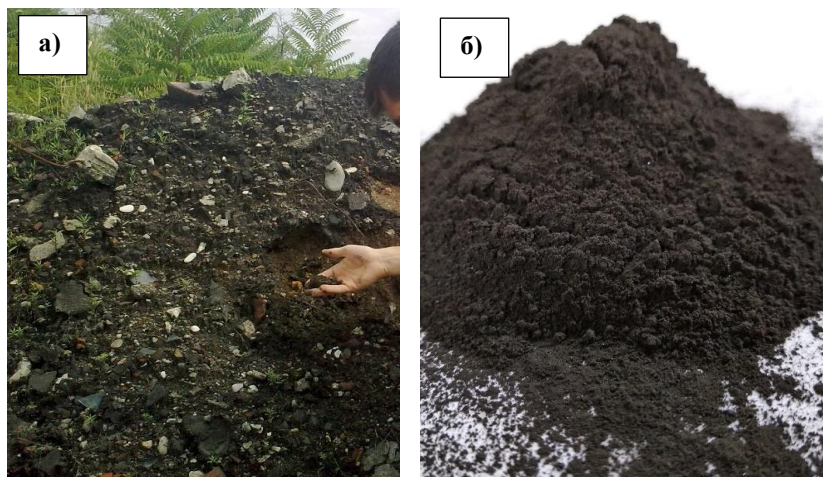
Рисунок 2 – Общий вид золошлаковых отходов в отвалах (а) и после их обработки (б) в лабораторных условиях
