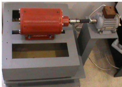
Рис. 1. Опытно-промышленный образец вибратора направленных действий с виброгенератором кассетного типа.
