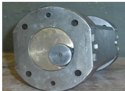
Рис. 2. Кассета виброгенератора с мощностью 1.0-1,5 кВт
