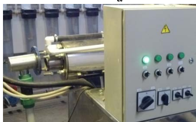
Рис. 2. Гидродинамический реактор с вращающимся электромагнитным слоем; а – внешний вид реактора, б – пульт управления
