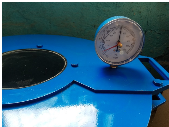
Рисунок 3 – Показания вакуумметра при отверждении металлополимера.
