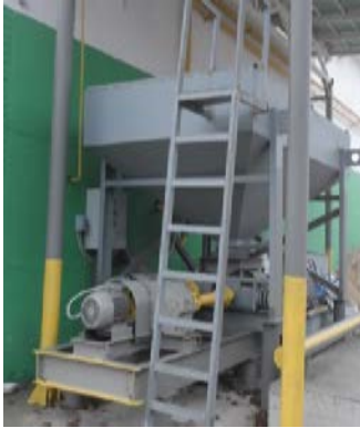
Рисунок 2 – Пресс-валковый измельчитель: а) общий вид, б) вид на установку в линии
