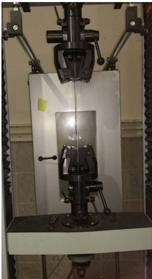
Рисунок 2 – Общий вид машины для испытания конструкционных материалов «УТС 110М-50» с установленным образцом
