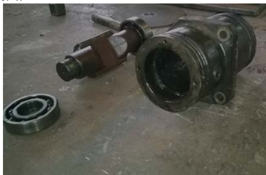
Рисунок 4 – Вибратор круговых колебаний
