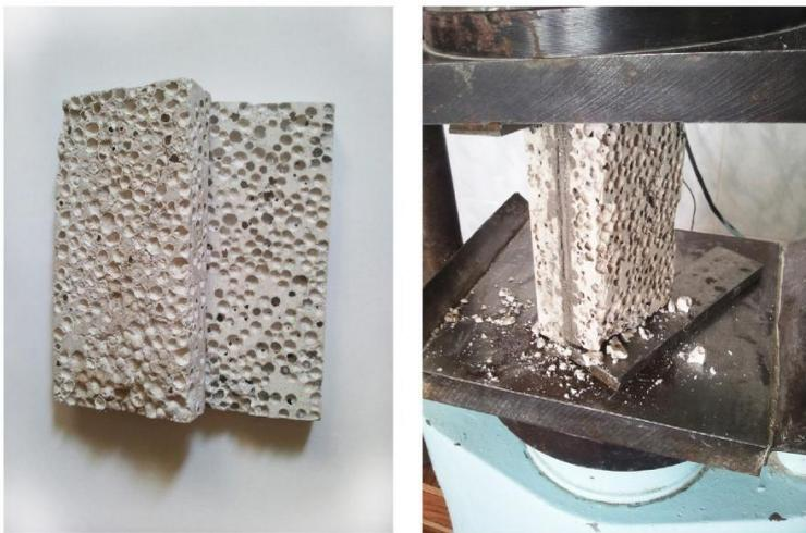
Рисунок 2 – Характер разрушения силикатных материалов с АГЗ при использовании упрочненных кладочных растворов
