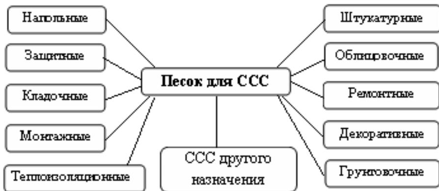
Рисунок 4 – Использование кварцевого песка в составах различных сухих строительных смесей
