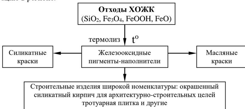
Рисунок 1 – Схема утилизации металлсодержащих отходов КМА.
