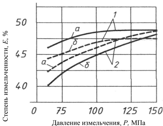
Рисунок 2 – График зависимости степени измельченности от давления измельчения: а- не футерованными валками; б- футерованными; 1-известняк органогенный; 2- клинкер;
