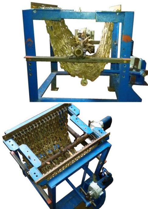
Рисунок 2 – Экспериментальная установка с цепным рабочим оборудованием
