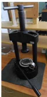
Рисунок 1 – Гидравлический пресс ПЛГ-20
