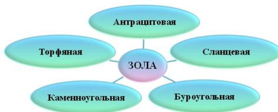
Рисунок 2– Классификация зол в зависимости от вида топлива
