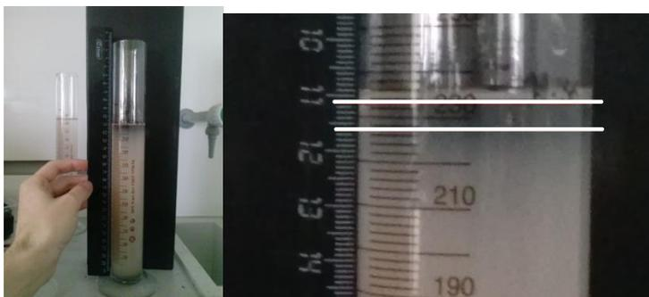
Рисунок 1 – Определение скорости осаждения частиц в воде
