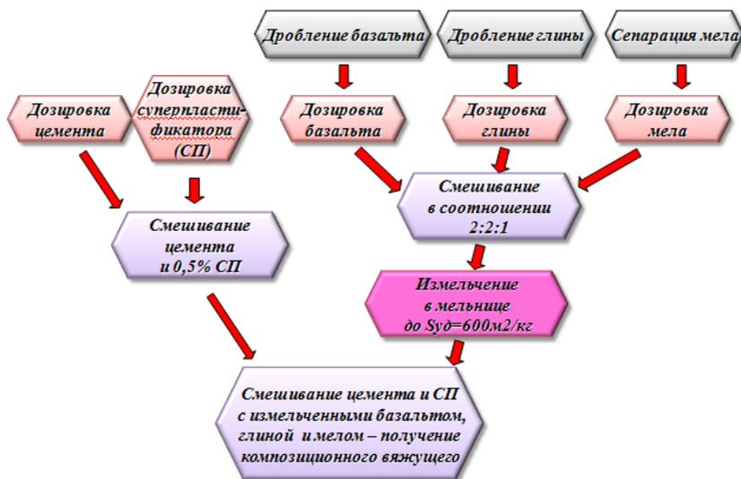
Рисунок 2 – Общая технологическая схема производства композиционного вяжущего
