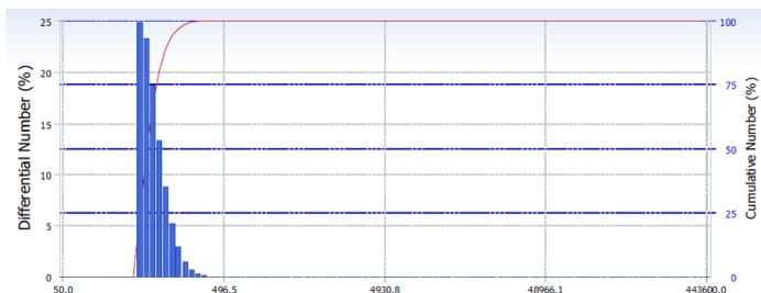
Рисунок 4 – График распределения по размерам частиц в CCl<sub>4</sub>
