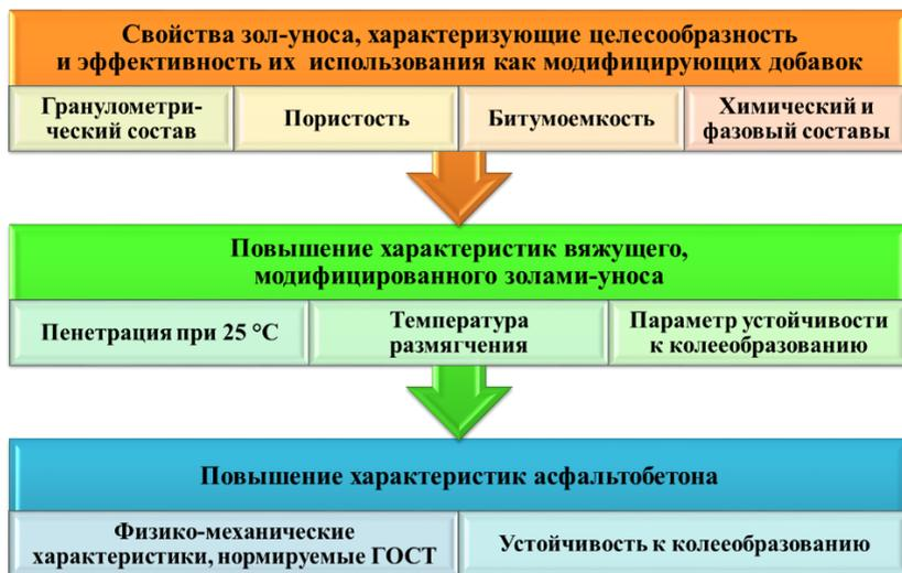
Рисунок 4 – Свойства зол-уноса и их влияние на свойства дорожно-строительных композитов
