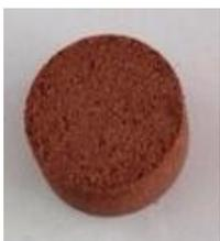
Рисунок 2 – Образец песчаного грунта с добавкой глиоксаля и сапонит-содержащего материала
