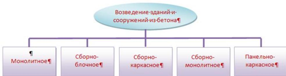
Рисунок 1 – Способы возведения зданий и сооружений из бетона
