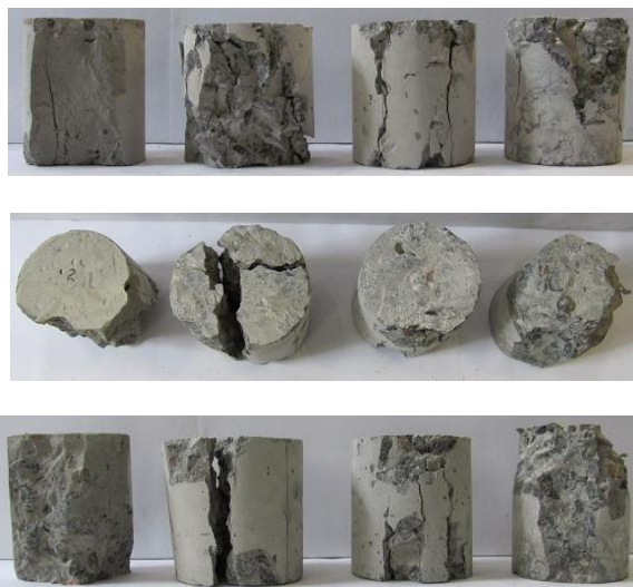
Рисунок 4 – Бетонные цилиндры, разрезанные на 4 части и испытанные на гидравлическом прессе
