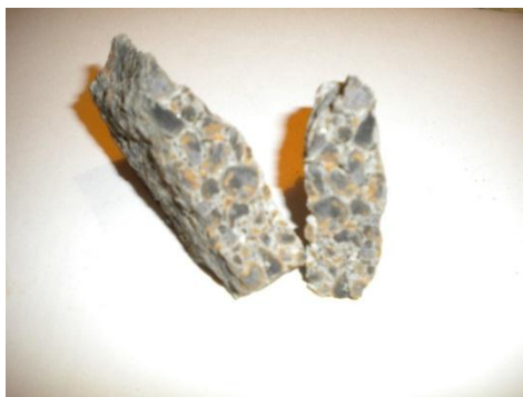
Рисунок 3 – Образец камня бетонного стенового СКЦ-1 М100 после испытаний на прочность
