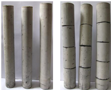
Рисунок 3 – Бетонные цилиндры, полученные путем длительного вибрирования и извлеченные из металлической обоймы
