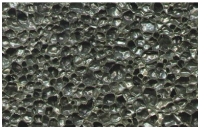
Рисунок 1 – Структура пеностеклокристаллического материала
