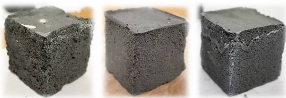
Рисунок 5 – Ячеистый геополимерный бетон в БГТУ им. В.Г. Шухова (слева-направо – газобетон, пенобетон, пеногазобетон)
