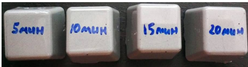
Рисунок 2 – Поверхность металлополимерной отливки при различном времени замешивания композитного состава
