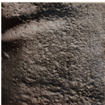
Рисунок 4 – Вид поверхности тарелки клапана (×4) в зоне ударно-абразивного изнашивания
