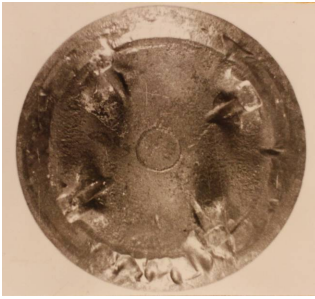
Рисунок 2 – Вид типичных повреждений тарелок клапанов геологоразведочных насосов Гр16/40
