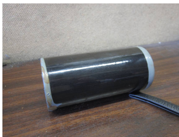
Рисунок 4 – Труба, покрытая лаком УФ-отверждения «UNIVERSUM-UV» после 240 ч испытания в камере соляного тумана
