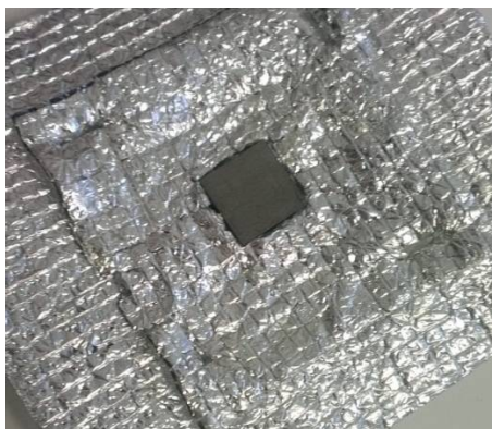
Рисунок 1 – Металлополимерный образец, установленный в теплоизоляционный элемент
