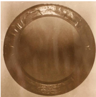
Рисунок 3 – Отработанные седла геологоразведочных насосов Гр16/40
