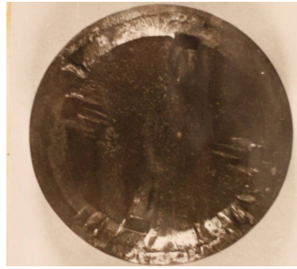
Рисунок 2 – Вид типичных повреждений тарелок клапанов геологоразведочных насосов Гр16/40
