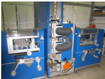
Рисунок 1 – Установка УФ-окраски оптоволоконного кабеля. Скорость 1800 м/мин
