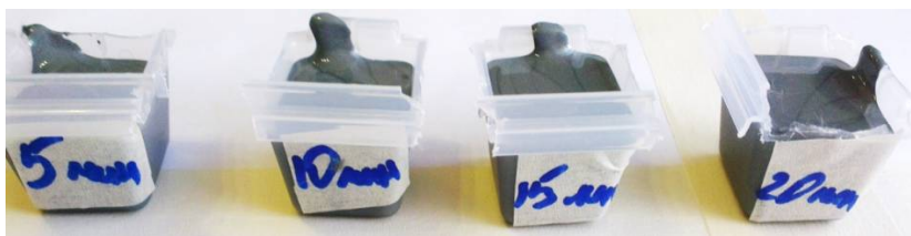
Рисунок 1 – Формы залитые жидким металлополимерным составом с различным временем замешивания
