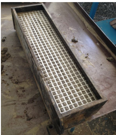
Рисунок 9 – Укладка второго слоя сетки
