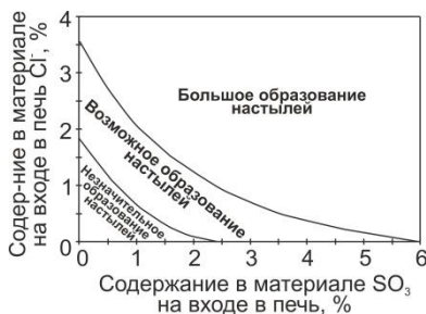
Рисунок 6 – Зависимость возможности образования настывлей от содержания \text{SO}_3 в материале
