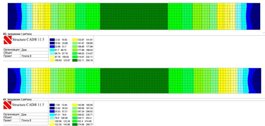
Рисунок 1 - Изополя изгибающего момента M_x : в плите 1-го типа (сверху), в плите 2-го типа (снизу)
