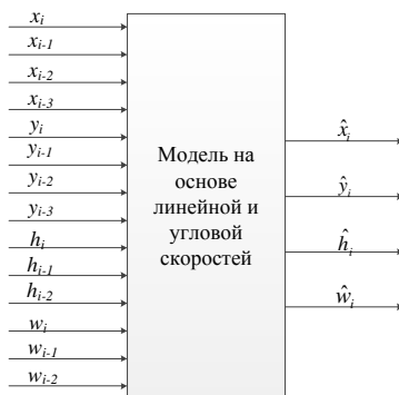
Рисунок 3 – Схема в виде чёрного ящика математической модели, используемой в алгоритме прогнозирования положения найденных объектов
