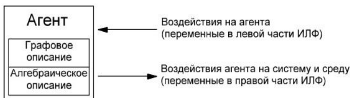
Рисунок 1 – Бинарный структурированный агент и его взаимодействие со средой
