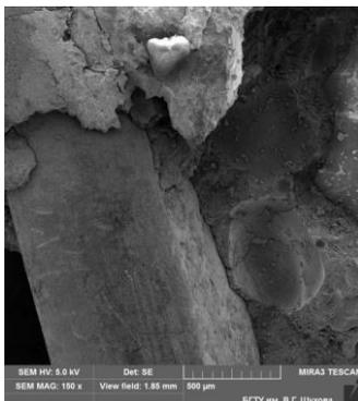
Рисунок 7 – Контактная зона фибры с композиционным вяжущим КВ100
