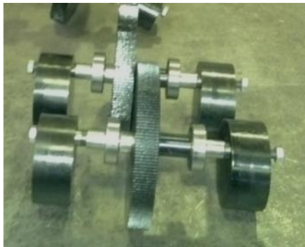
Рисунок 2 – Комплект одной пары валов с дебалансами
