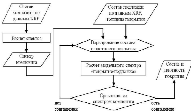
Рисунок 10 – Алгоритма расчета состава покрытия (XRF – рентгеновая флуоресценция)
